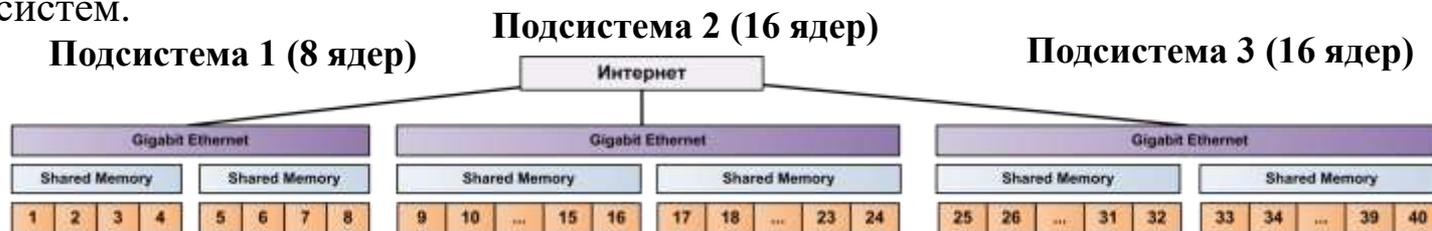
Для современных распределённых ВС систем характерны иерархическая организация и различные пропускные способности каналов связи между их ресурсами.
