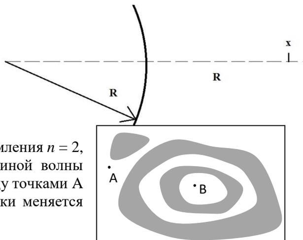
2. На рисунке схематически изображена картина интерференционных полос равной толщины на тонкой плёнке с показателем преломления  $n = 2$ , наблюдаемая по нормали к ней в свете с длиной волны  $\lambda = 0,5$  мкм. Оцените перепад толщины  $\Delta h$  между точками А и В, считая, что на отрезке АВ толщина плёнки меняется монотонно. (3 б).
