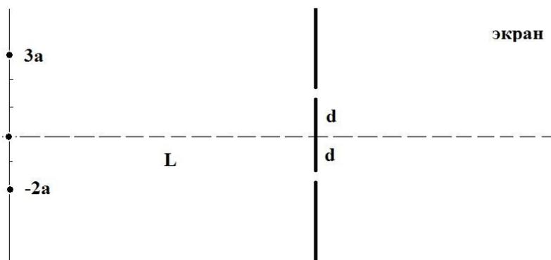
3. В схеме Юнга экран с двумя узкими щелями освещается тремя монохроматическими узкими вытянутыми в линии источниками одинаковой интенсивности с длиной волны  $\lambda$ . Источники расположены на расстоянии  $L \gg d$  от экрана со щелями, расстояние между щелями  $2d$ . Источники
