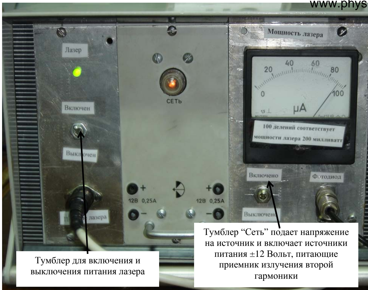
Рис. 13. Фотография лицевой панели источника питания лазера и усилителя фотоприемника, измеряющего интенсивность второй гармоники.
