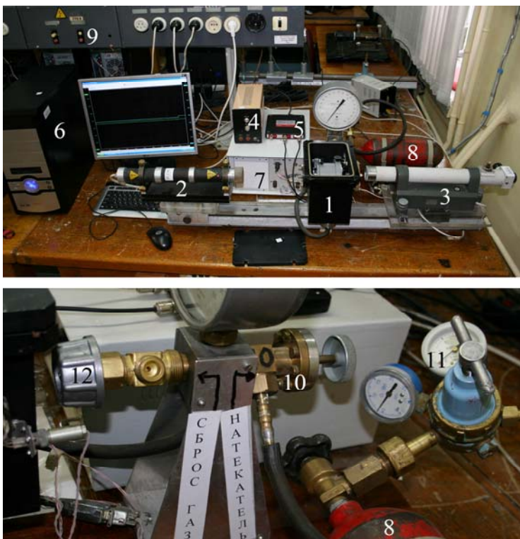
Рис. 3. Фотография установки для измерения показателя преломления: 1- барокамера с интерферометром, 2 – лазер, 3 – коллиматор, 4 – блок питания лазера, 5 – осциллограф, 6 – компьютер, общий с лабораторной работой 3.6., 7 – блок питания установки, 8 – баллон с исследуемым газом, 9 – сетевой автомат, 10 – натекатель, 11 – редуктор, 12 – выпускной вентиль.
