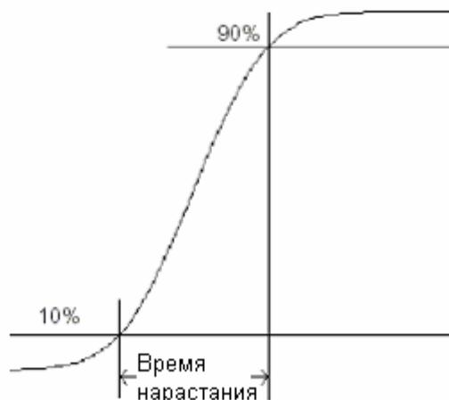
Рис. 4. Определение времени нарастания сигнала
