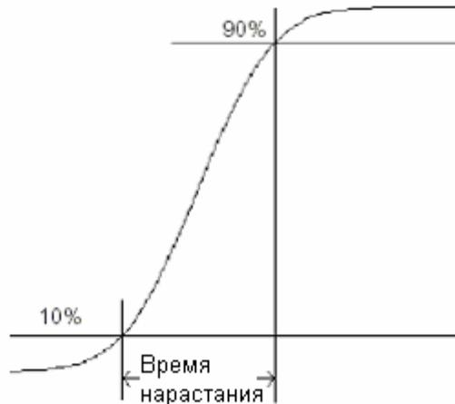
Рис. 4. Определение времени нарастания сигнала
