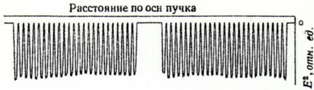
Рис. 19. Распределение амплитуд аксиального поля по длине ускорительного тракта в секции K при установленном соединительном устройстве.
