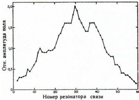
Рис. 11. Амплитуды электрических полей в резонаторах связи секции K после настройки.
