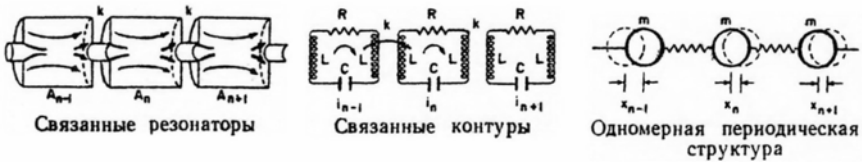
Рис. 1. Соответствие между цепочкой связанных объемных резонаторов, системой связанных колебательных контуров и одномерной периодической структурой.
