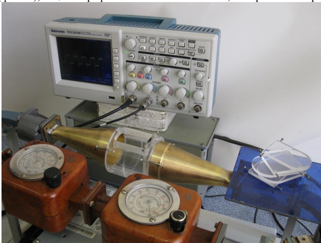
Установка " Микроволновый интерферометр"
