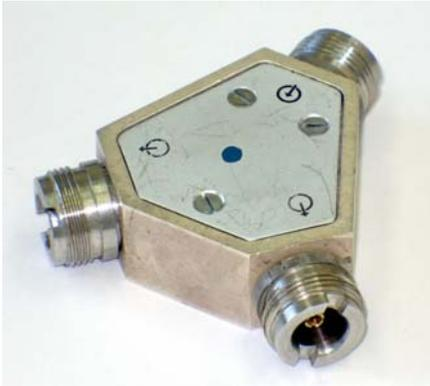
Рис. 16. Коаксиальный мост.
