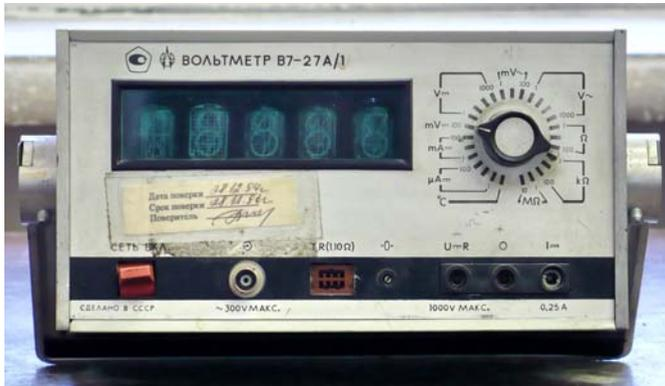
Рис. 20. Цифровой вольтметр В7-27А.
