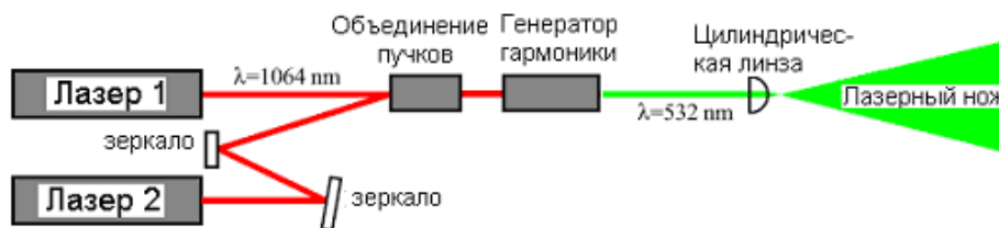
Рис. 18.3 Схема излучателя для метода PIV диагностики
