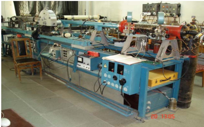
Рис.26.2. Схема эксперимента и общий вид ударной трубы УТ-4М.
