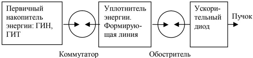
Рис. 12. Блок-схема ускорителя прямого действия
