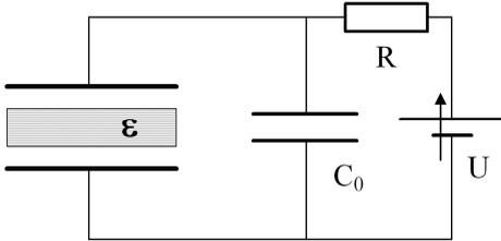
воздушного конденсатора, расстояние между которыми  $d$ , закреплен изолирующий слой толщиной  $d/2$  с относительной диэлектрической проницаемостью  $\varepsilon$ . Система подключена к источнику постоянного напряжения  $U$  и к емкости  $C_0$  по схеме, изображенной на рисунке.
