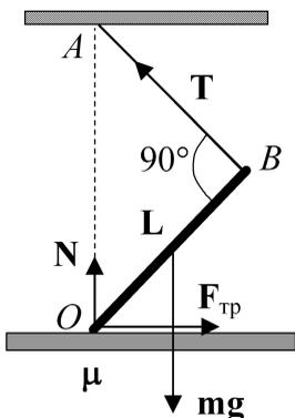
Вертикально вниз действует сила тяжести  $mg$ , всегда приложенная к центру масс тела. Вертикально вверх – сила реакции опоры  $N$ , всегда перпендикулярная поверхности, на которую опирается тело. Вправо – сила трения  $F_{тр}$ , всегда направленная вдоль поверхности. И, наконец, влево и вверх – сила натяжения нити  $T$ . Следует хорошо прочувствовать и четко запомнить, что нить всегда тянет тело на себя и никогда его от себя не отталкивает!
