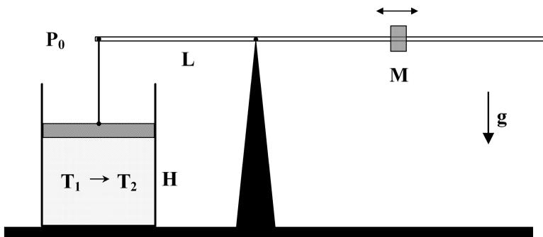
равна  $T_1$  и вся система уравновешена (см. рис.). Газ нагревают до температуры  $T_2$ . На какую величину и в какую сторону при этом нужно сдвинуть противовес вдоль коромысла, чтобы оно осталось горизонтальным? Ускорение свободного падения  $g$  известно. Атмосферным давлением  $P_0$  не пренебрегать.
