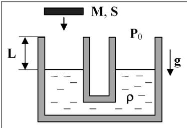
(на рисунке – левый) с площадью внутреннего поперечного сечения  $S$  закрывают поршнем массы  $M$ , плотно прилегающим к достаточно высоким стенкам и способным скользить вдоль них без трения. В сосудах находится жид-
