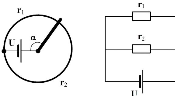
льно, и это параллельное соединение подсоединено к источнику напряжения. Соответственно, эквивалентную схему нашего устройства можно изобразить в виде, представленном на рисунке справа. *Полное сопротивление  $r_0$  пары параллельно соединенных проводников с индивидуальными сопротивлениями  $r_1$  и  $r_2$  выражается известной формулой:*
