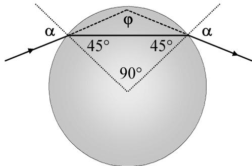
б) Если обозначить угол падения луча на поверхность шара через  $\alpha$ , то в показанном на рисунке другом равнобедренном треугольнике с углом при вершине  $\Phi$  каждый из одинаковых углов при основании равен по  $(\alpha - 45^\circ)$ . При этом сумма углов данного (как и любого другого) треугольника равна  $180^\circ$ , что можно выразить соотношением:
