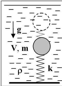
расстояние  $x$  сместится поплавок после того, как его отпустят и колебания пружины успокоятся? Какую суммарную работу  $A$  совершит при этом сила Архимеда? Ускорение свободного падения  $g$  известно.
