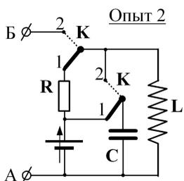
**ЗАДАЧА № 78.** Во внутренний объем теплоизолированного калориметра встроено электрическое сопротивление (резистор), концы которого выведены наружу и могут быть подсоединены к контактам А и Б одной (опыт 1) или другой (опыт 2) элек-
