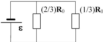
Эквивалентная схема рассматриваемой электрической цепи показана на рисунке. Из нее хорошо видно, что источник напряжения нагружен на два сопротивления, соединен-
