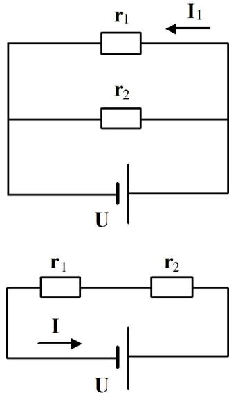
Известно, что *полное сопротивление цепи, состоящей из последовательно соединенных сопротивлений, равно сумме этих сопротивлений*. В результате, из закона Ома, записанного для участка, где последовательно соединены сопротивления  $r_1$  и  $r_2$ , следует, что
