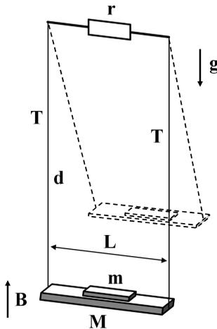
“сиденье” длиной  $L$  и массой  $M$ , а также легкие жесткие прутья длиной  $d$ , являются идеальными проводниками. На центр “сиденья” положили маленький деревянный брусок массы  $m$ , затем качели отклонили и отпустили (см. рис.). При проходе нижней точки, где плоскость “сиденья” была горизонтальной, включили вертикально направленное однородное магнитное поле с индукцией  $B$ .
