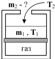
Теплопроводящая перегородка, под которую помещен идеальный газ. Выше перегородки налита жидкость массы  $m_1 = 4$  кг при температуре  $T_1$ . Система находится в термодинамическом равновесии (см. рис.). Какую массу  $m_2$  такой же жидкости при температуре  $T_2 = kT_1$  (где  $k = 1.3$ ) нужно добавить в сосуд, чтобы после прихода к новому
