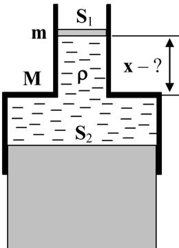
тонкостенных труб с площадями поперечного сечения  $S_1$  и  $S_2$ , надели плотно, но без трения, в присутствии поля тяжести на вертикальный закрепленный стержень с площадью поперечного сечения  $S_2$ , как показано на рисунке. Во внутреннее пространство фигуры налили жидкость плотности  $\rho$ , герметично "закупорив" ее сверху тонким поршнем площади  $S_1$  и массы  $m$ , тоже скользящим по
