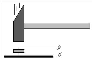
пластичных материалов, произвели удар, в результате чего его пластины расплющились и стали в 1.5 раза больше по площади, а зазор между пластинами уменьшился в 2 раза (см. рис.). Заряд на конденсаторе и относительная диэлектрическая проницаемость изолятора остались прежними. Во сколько раз и в какую сторону изменилась энергия электрического поля в конденсаторе в результате удара?
