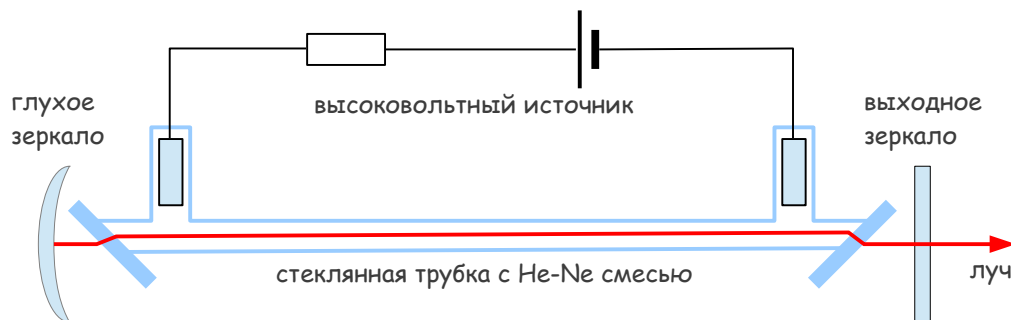
Рис. 3.1. Схема He-Ne лазера. Торцы стеклянной трубки заклеены прозрачными пластинками под углом Брюстера
