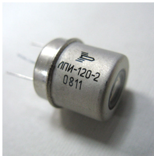
Рис. 3.8. Полупроводниковый лазер ЛПИ-120
