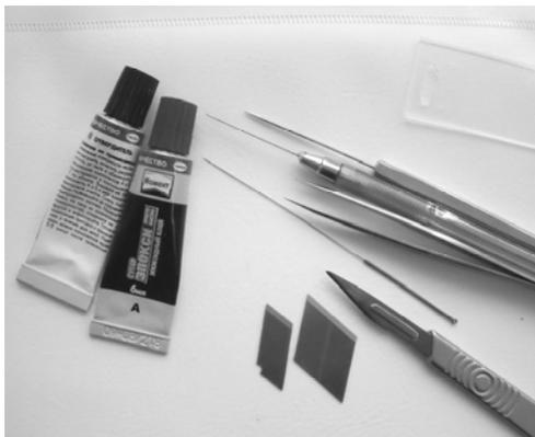
Рис. 5.2. Типичный набор манипуляторов, используемых кристаллографом, занимающимся отбором монокристаллов для РСА.
