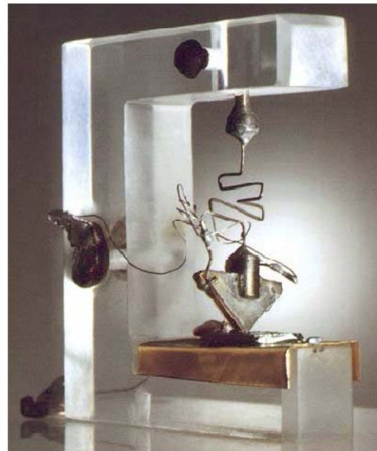
Рис. 2. Первый транзистор Уильяма Шокли, Джона Бардина и Уолтера Браттейна.
