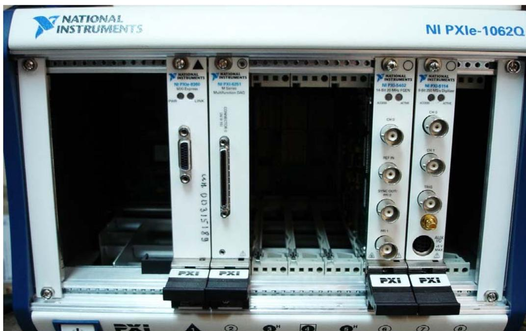
Рисунок 5. Кейт с модулями PXI, используемыми в работе
