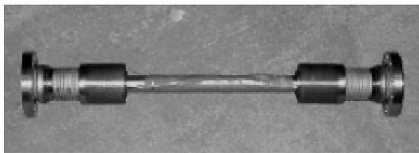
Fig. 1. Magnesium vapor target.
