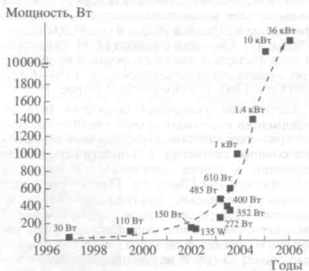
Рис. 3. Рост максимальной выходной мощности непрерывных волоконных лазеров за последние 10 лет
