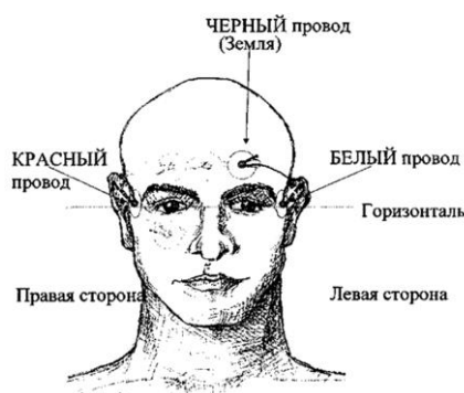
Рис. 50. Схема присоединения электродных проводов к электродам для горизонтального отведения
