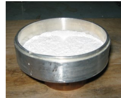
Держатель с образцом перед помещением в вакуумную камеру после испарения азота
