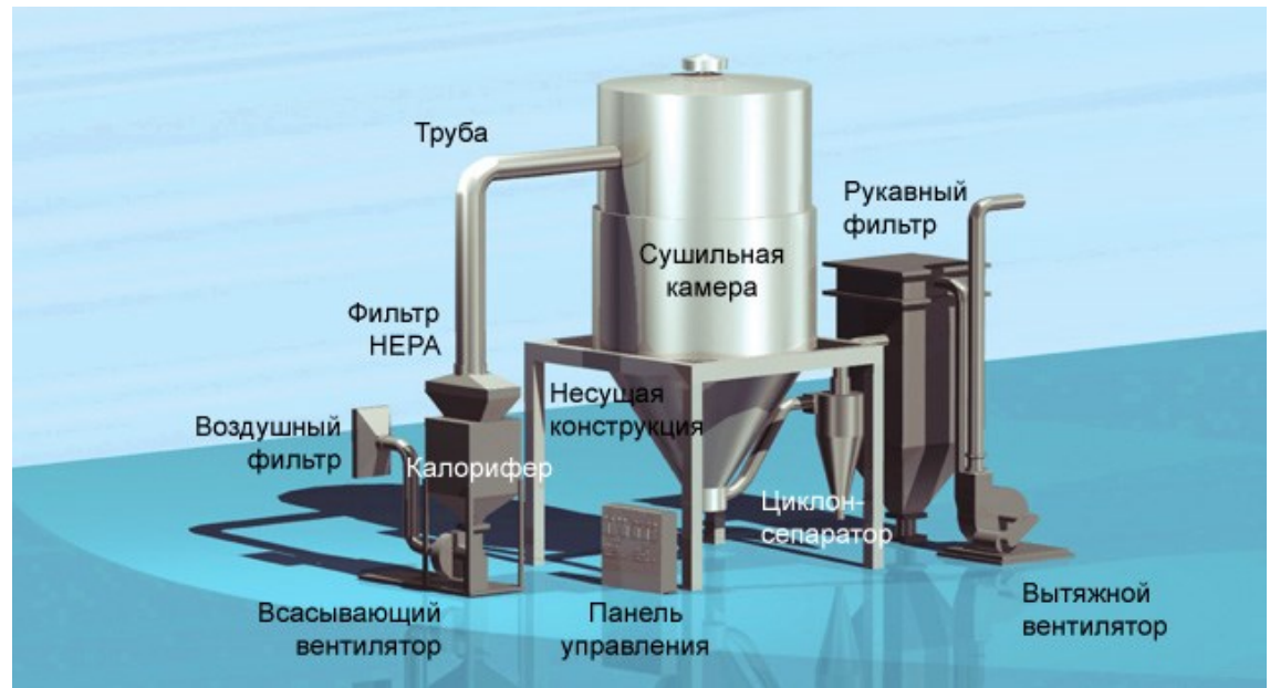
Общий вид и основные модули промышленной установки распылительной сушки
