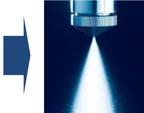
Распыление раствора в емкость с жидким азотом ( P_{\text{изб.}} \sim 1 \text{ атм.} , d_{\text{капилляр}} \sim 0.4 \text{ мм.} )
