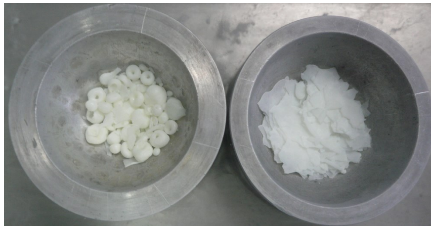
Образцы замороженного раствора мелоксикама и янтарной кислоты в 1,4-диоксане. «Стекло» и замерзшие капли после разделения.
