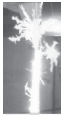
Рис. 2. Факел горения топлива 3. Горизонтальная полоска в нижней части изображения – срез стаканчика диаметром 1 см
