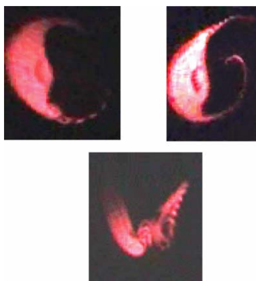
10. Картины дымовой визуализации поперечного сечения струи, подверженной вторичной высокочастотной неустойчивости при акустическом воздействии на нее
