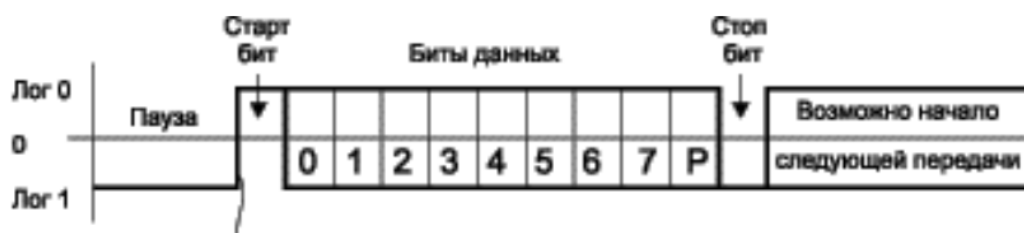
Рисунок 4. Формат асинхронной передачи RS-232C
