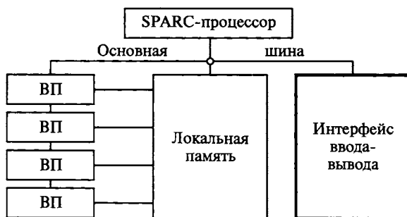
Рис. 5.12. Функциональная структура процессорного узла CM-5:
