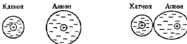
Рис. 29. Электронная поляризация аниона катионом
