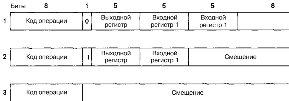
Рис. 5.16. Разработка форматов команд для трехадресной машины
